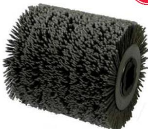
Con foro d'attacco Ø mm 19,1 e sede per chiavetta. Adatte per le più diffuse smerigliatrici, lucidatrici e satinatrici. In filo di resistente nylon, ricoperto di graniglia abrasiva. Per sbavare e pulire superfici non metalliche e metalliche
